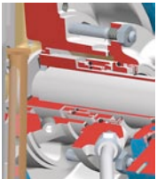
MQ3 HJ92N / HJ977GN Enkele mechanische asafdichting, gebalanceerd, droogloopbeveiliging, asbus
